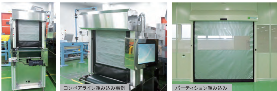
コンベアライン組み込み事例
