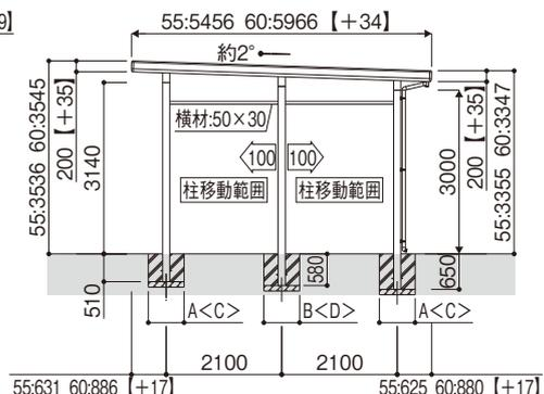
※( )は、ハイルーフの寸法です。また、DX鼻隠しタイプでは【 】内の数値を加算してください。 寸法図: 縮尺1/150(単位mm)
