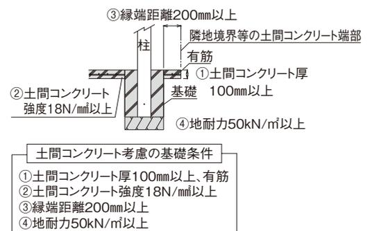
■セット内容および組合せサイズにより、柱ごとに施工時の基礎寸法が異なります。また、(土間コンクリート考慮の場合)の基礎条件は、下図の内容となります。
