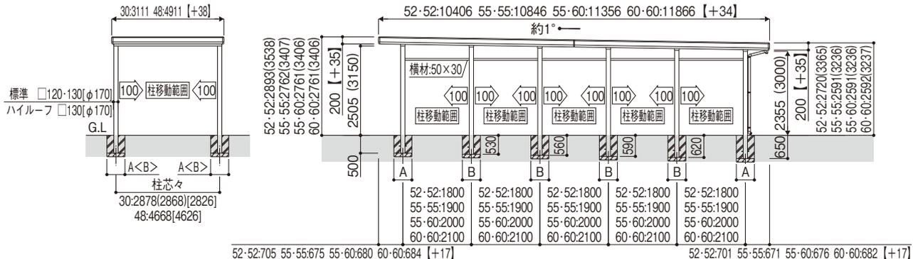
※( )は、ハイールーフの寸法です。[ ]は、丸柱での寸法です。ただし、幅48サイズのみ標準タイプも柱は□130となります。また、DX鼻隠しタイプでは【 】内の数値を加算してください。
