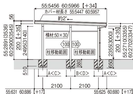
※( )は、ハイライフの寸法です。[ ]は、丸柱での寸法です。また、DX鼻隠しタイプでは【 】内の数値を加算してください。寸法図:縮尺1/150(単位mm)
