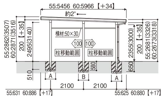
※( )は、ハイルーフの寸法です。【 】は、丸柱での寸法です。また、DX鼻隠しタイプでは【 】内の数値を加算してください。寸法図: 縮尺1/150 (単位mm)
