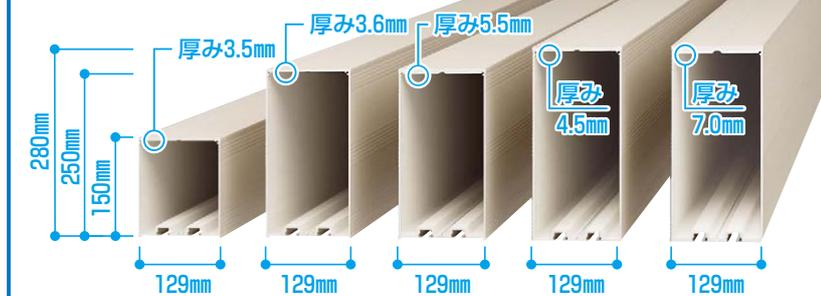
「ジーポート neo」は長期積雪荷重対応の商品です。その高い性能を確保するために、5種類の梁をご用意。
