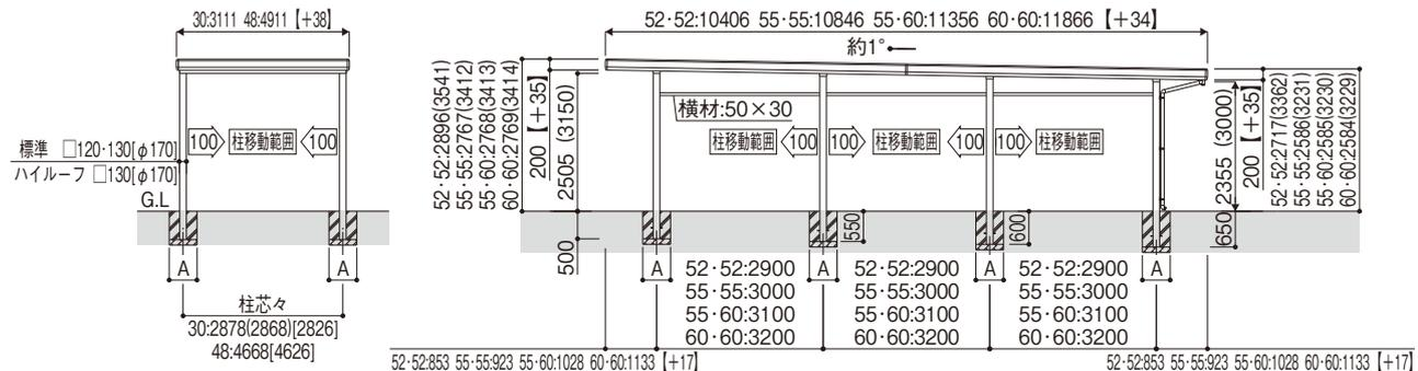
※【 】は、ハイールーフの寸法です。【 】は、丸柱での寸法です。ただし、幅48サイズでのみ標準でも柱は□130となります。また、DX鼻隠しタイプでは【 】内の数値を加算してください。
