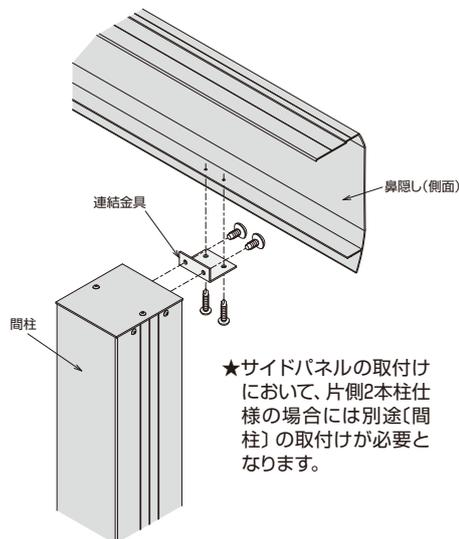
★サイドパネルの取付けにおいて、片側2本柱仕様の場合には別途〔間柱〕の取付けが必要となります。
