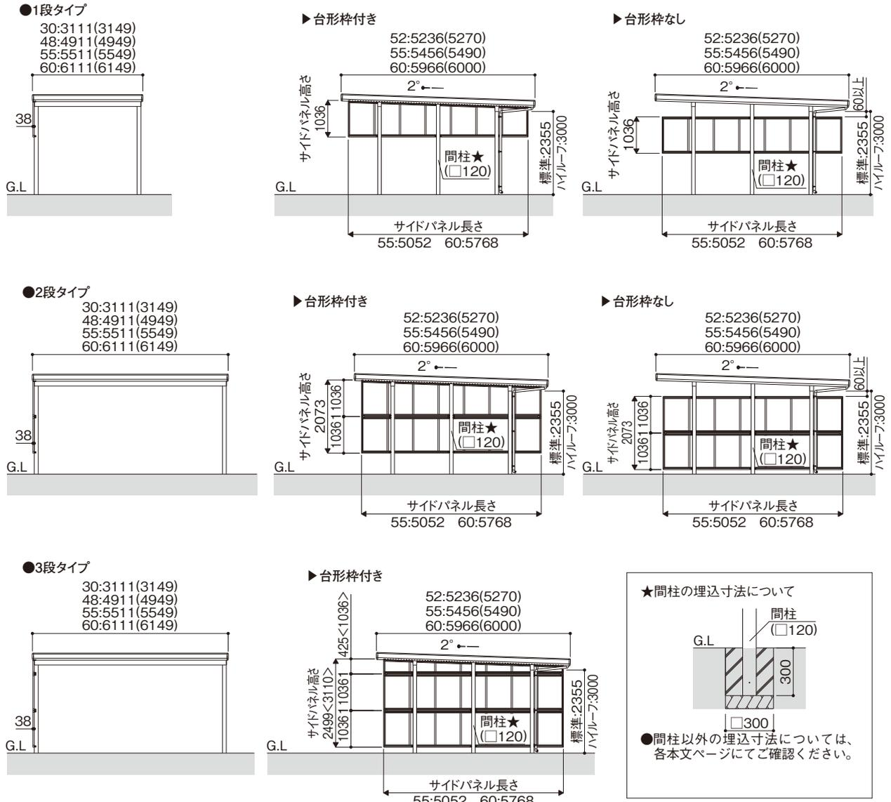
たて(2)連棟セット用サイドパネル (=基本セット用サイドパネル+たて連棟用セット用サイドパネル)
