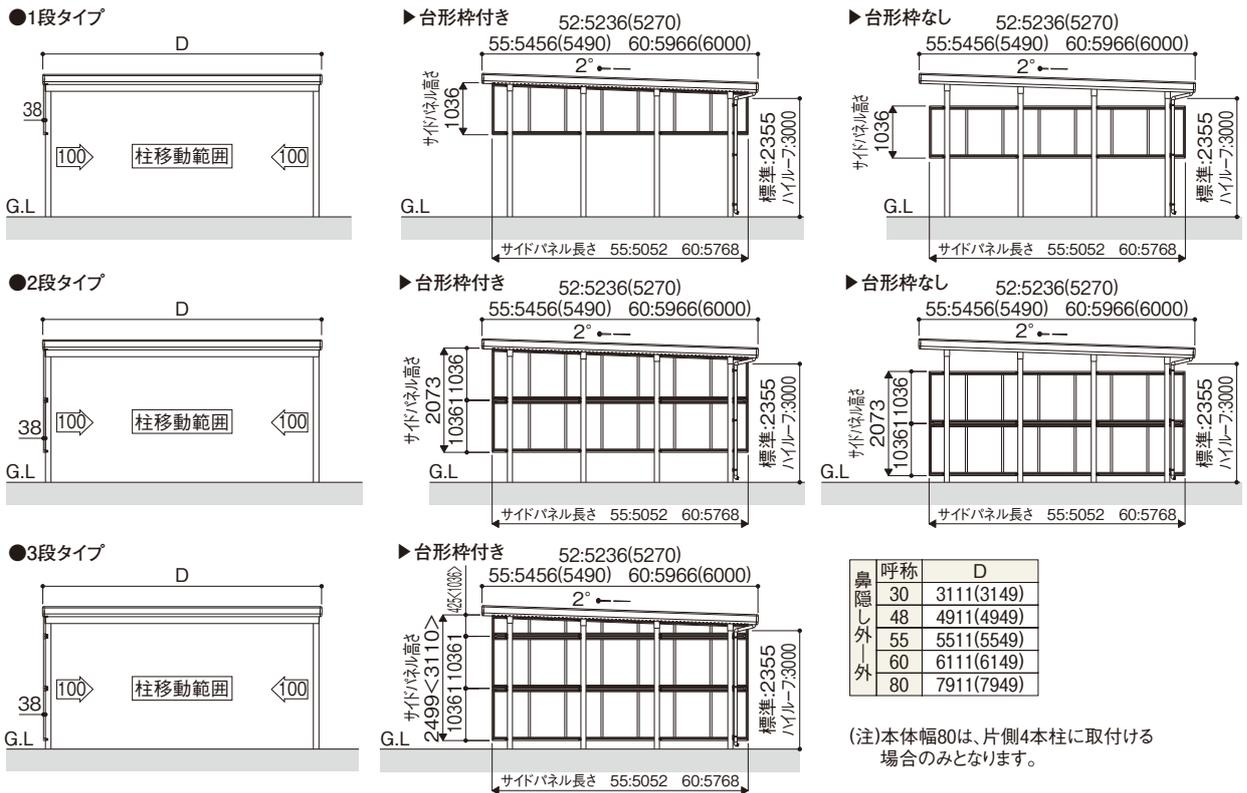
たて(2)連棟セット用サイドパネル (=基本セット用サイドパネル+たて連棟用セット用サイドパネル)
