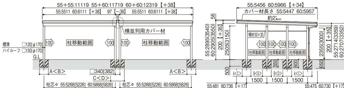
※( )は、ハイールーフの寸法です。【 】は、丸柱での寸法です。また、DX鼻隠しタイプでは【 】内の数値を加算してください。寸法図:縮尺1/150(単位mm)
