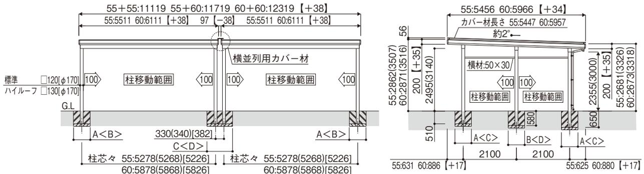
※( )は、ハイライフの寸法です。[ ]は、丸柱での寸法です。また、DX鼻隠しタイプでは【】内の数値を加算してください。寸法図:縮尺1/150(単位mm)
