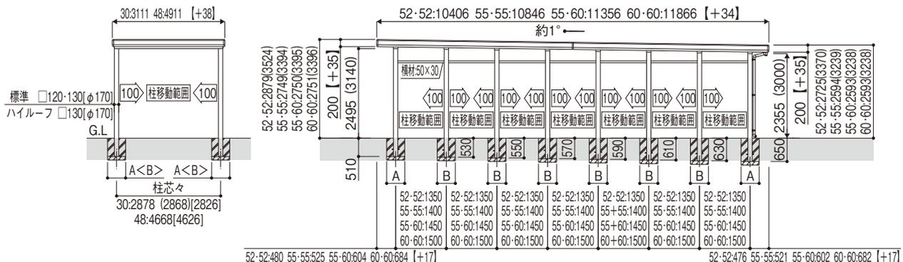
※( )は、ハイライフの寸法です。【 】は、丸柱での寸法です。ただし、幅48サイズでのみ標準でも柱は□130となります。
